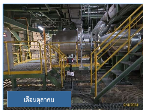
ภาพที่ 3.49 การตรวจวัดความร้อนในสถานที่ทำงานบริเวณเครื่องอบให้ความร้อนชุบเคลือบ (Galvannealing Heater Process)
