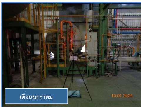
ภาพที่ 3.42 การตรวจวัดระดับเสียงในสถานที่ทำงานบริเวณ Post Treatment Dryer
