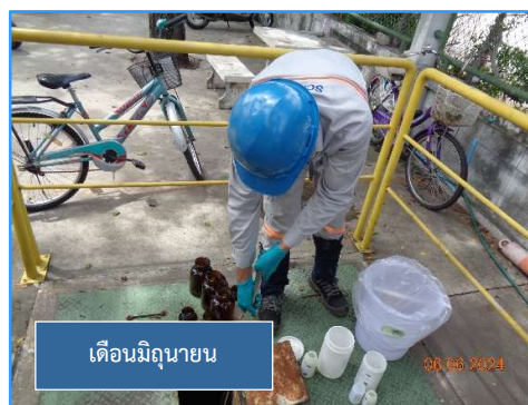
ภาพที่ 3.17 การตรวจวัดคุณภาพน้ำบริเวณบ่อตรวจสอบคุณภาพน้ำขนาด 50 ลบ.ม. ก่อนระบายลงระบบรวมน้ำเสียของนิคมอุตสาหกรรมดับบลิวเอชเอตะวันออก (มาบตาพุด)
