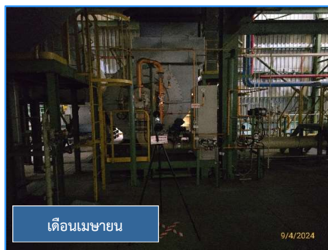
ภาพที่ 3.42 การตรวจวัดระดับเสียงในสถานที่ทำงานบริเวณ Post Treatment Dryer
