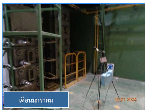
ภาพที่ 3.41 การตรวจวัดระดับเสียงในสถานที่ทำงานบริเวณ Water quench dryer
