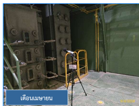
ภาพที่ 3.41 การตรวจวัดระดับเสียงในสถานที่ทำงานบริเวณ Water quench dryer
