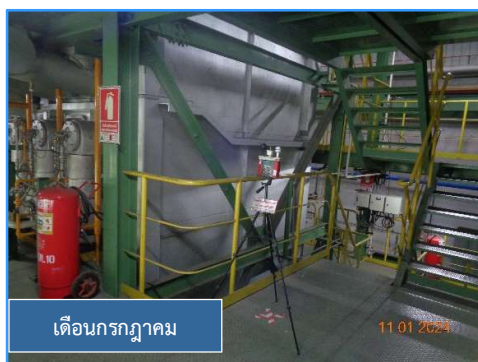
ภาพที่ 3.48 การตรวจวัดความร้อนในสถานที่ทำงานบริเวณเครื่องอบให้ความร้อน (Annealing Heater)
