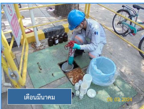
ภาพที่ 3.17 การตรวจวัดคุณภาพน้ำบริเวณบ่อตรวจสอบคุณภาพน้ำขนาด 50 ลบ.ม. ก่อนระบายลงระบบรวมน้ำเสียของนิคมอุตสาหกรรมดับบลิวเอชเอตะวันออก (มาบตาพุด)
