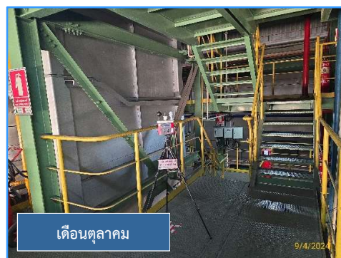
ภาพที่ 3.48 การตรวจวัดความร้อนในสถานที่ทำงานบริเวณเครื่องอบให้ความร้อน (Annealing Heater)
