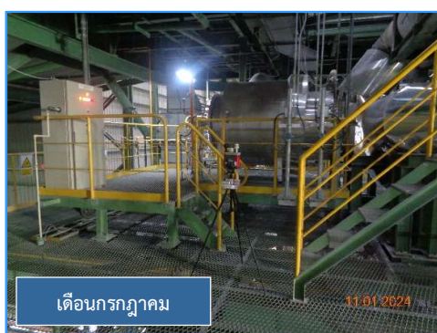
ภาพที่ 3.49 การตรวจวัดความร้อนในสถานที่ทำงานบริเวณเครื่องอบให้ความร้อนชุบเคลือบ (Galvannealing Heater Process)
